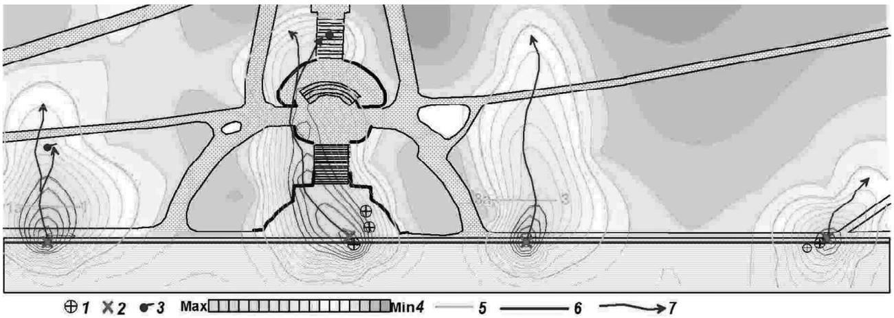
Рис. 7. Карта зон повышенного увлажнения грунтов в районе центральной лестницы парка НТУУ (КПИ). 1 – люки; 2 – места утечек; 3 – участки вытоков воды на поверхность; 4 – шкала относительной влажности грунта; 5 – профили сейсмоакустического зондирования; 6 – линия подземной водной коммуникации (канализация); 7 – направление подземных водных потоков
