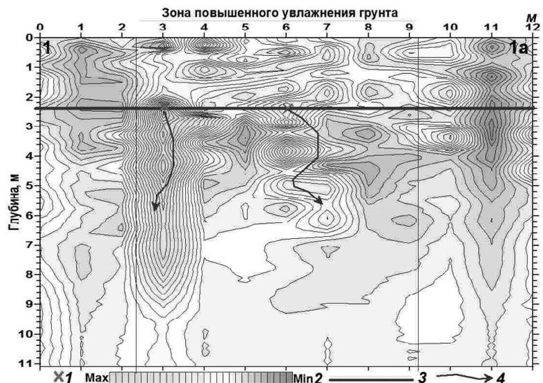
должается до 40 м. Здесь, между ступенями лестницы, происходит просачивание воды на поверхность. По данным зондирования ВЭРЗ, глубина области намочения пород под лестницей до 5 м. В колодце под люком по состоянию на 10 сент. 2006 г. стояла вода (1,5 м). В районе люка определены максимальные значения увлажнения грунта в интервале 2–5 м. Водный поток, который ниже выходит на поверхность лестницы, вытекает у этого колодца.
