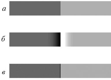
*Рис. 2. Підвищення контрасту меж зображення: а – вихідне зображення; б – межа контрастована методом “нерізкої маски” [7]; в – межа, контрастована використанням оператора Лапласа*
