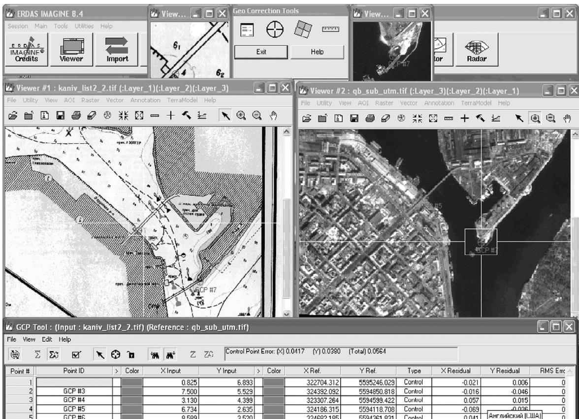
Рис. 3. Процес географічної прив'язки карти до космічного знімку та векторної карти за набором контрольних точок
