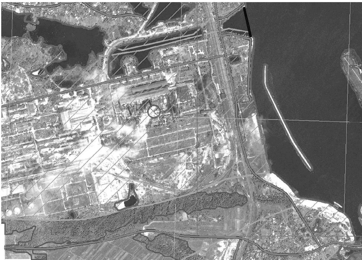
Рис. 2. Фрагмент космофотоплану на територію Канівського водосховища з віддесшифрованими векторними шарами берегової лінії, лісів, мостів, контурів населених пунктів, причалів, навігаційних орієнтирів
