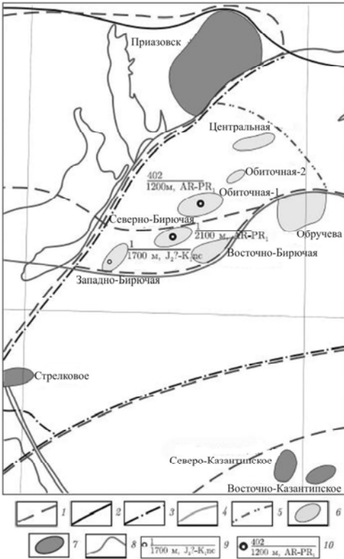
Рис. 3. Перспективный участок для проведения геологоразведочных работ на нефть и газ в пределах Чингульской седловины [18]: 1 – тектонические нарушения; границы: 2 – перспектив нефтегазоносности, 3 – нефтегазоносных областей, 4 – нефтегазоносных районов, 5 – участка, рекомендованного для проведения детальных сейсморазведочных исследований МОГТ; 6 – локальные структуры; 7 – газовые месторождения; 8 – береговая линия; 9 – пробуренные скважины: над чертой – их номер, под чертой – глубина забоя, возраст отложений; 10 – проектные скважины: над чертой – их номер, под чертой – проектная глубина, горизонт
