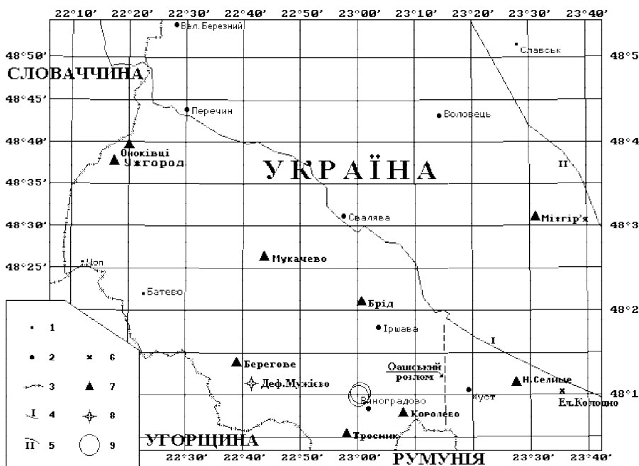
Рис. 1. Мережа сейсмічних та комплексних режимних геофізичних станцій (РГС) і окремих пунктів геофізичних спостережень у Закарпатті: 1, 2 – населені пункти; 3 – державні кордони; 4 – Закарпатський розлом, 5 – границя між зовнішньою і внутрішньою зонами Карпат (за В. Глушком та С. Кругловим); 6 – геоелектричний пункт Колодно; 7 – РГС та сейсмічні станції; 8 – деформографічний та геоакустичний пункт Мужєво; 9 – епіцентри Виноградівських землетрусів 5–6 травня 1989 р.)
