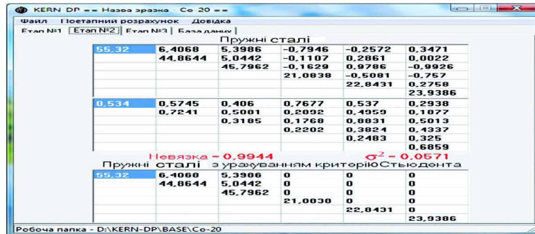
Рис. 5. Вікно завершеного другого етапу обробки даних ультразвукових вимірювань анізотропії швидкостей V у гірській породі
