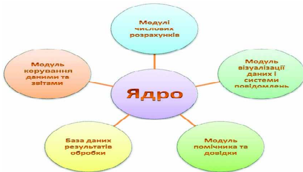
Рис. 2. Загальна блок-схема АС обробки даних ультразвукових вимірювань анізотропії швидкостей V в гірських породах
