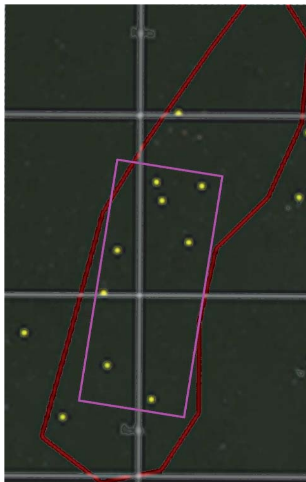
Рис. 5. Фрагмент спутникового снимка участка расположения месторождений Белый Тигр и Дракон на шельфе Вьетнама. Желтые (светлые) точки — положение буровых платформ, красный многоугольник — приближенный контур месторождения Белый Тигр, прямоугольный контур — локальный участок дополнительной (детальной) частотно-резонансной обработки
