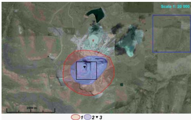
Рис. 5. Геоэлектрические аномальные зоны над кимберлитовой трубкой «Letseng-La-Terae» (Королевство Лесото). Зона регистрации откликов на резонансных частотах: 1 — кимберлитов, 2 — алмазов; 3 — точка вертикального сканирования
