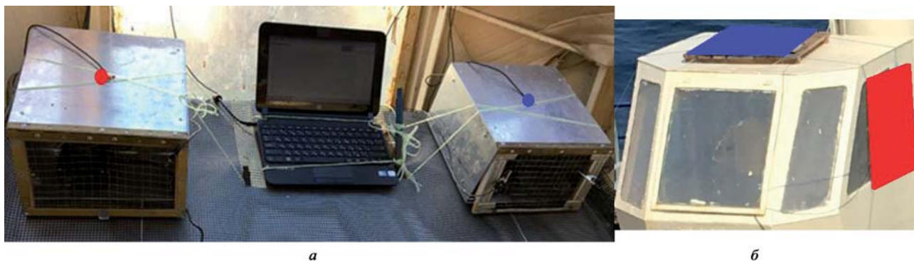
Рис. 4. Комплект аппаратуры: а — для регистрации напряженности электрического поля Земли (флюксметр в правой коробке) и изменения электрического заряда в зоне измерения в зависимости от метеорологических условий (флюксметр в коробке слева); б — размещение пластин (антенн) на кабине крана для регистрации изменений напряженности естественного электрического поля
