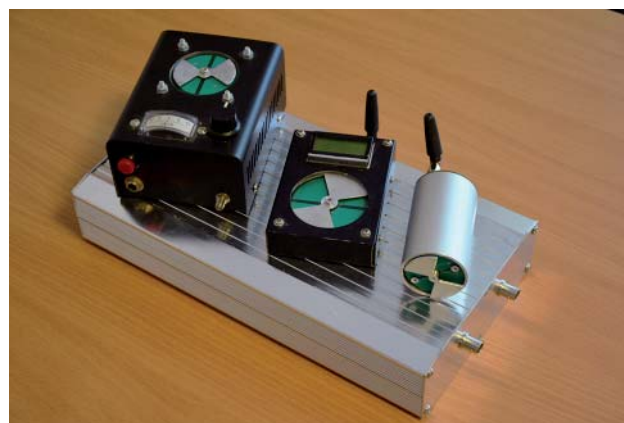
Рис. 3. Измерительная аппаратура: на генераторе длинных линий (алюминиевая коробка) размещены три модификации флюксметра [1, 41]
