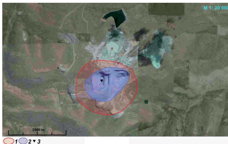
Рис. 15. Геоэлектрические аномальные зоны над кимберлитовой трубкой «Letseng-La-Terae» (Королевство Лесото): 1 — зона регистрации откликов на резонансных частотах кимберлитов; 2 — зона регистрации откликов на резонансных частотах алмазов; 3 — точка вертикального сканирования
