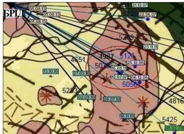
Рис. 4. Фрагмент розподілу швидкостей пробігу прямої P -хвилі для сейсмостанції Брід
