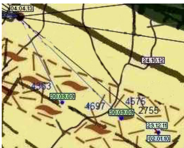
Рис. 6. Фрагмент розподілу швидкостей пробігу прямої P-хвилі для сейсмостанції Нижнє Селище
