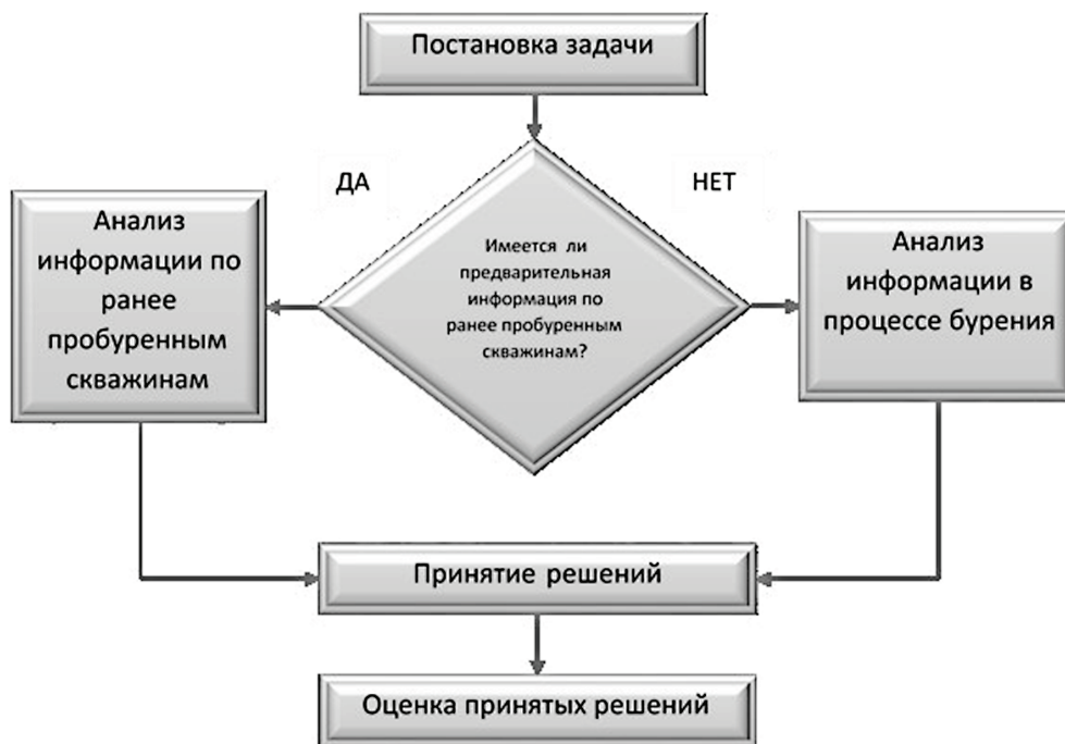
Рис. 1. Блок-схема принятия решений при бурении скважин в зависимости от характера исходной информации Fig. 1. A block diagram of decision-making during drilling, depending on the nature of the initial information
