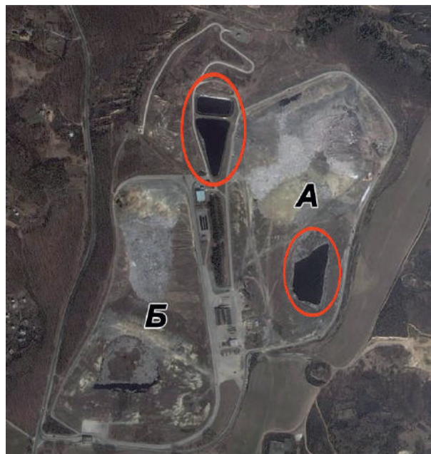
Рис. 2. Дистанційне зображення Київського полігона № 5 станом на 2006 р., зроблене з космічного апарата Quick Bird, на якому чітко дешифруються площі відкритих дзеркал озер для збору фільтрату (окреслено червоним кольором): А, Б – карти полігона
