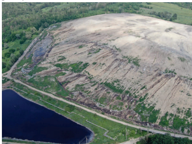
Рис. 5. Перспективне дистанційне зображення північно-західної частини полігона № 5, зроблене з безпілотного літального апарата 31.05.2019 р., на якому простежуються місця височування фільтрату (чорно-коричневий колір) з «тіла» сміттєзвалища, стікання його по схилу і накопичення у підніжжі карти «А», а також поверхня найбільшого ставка-фільтратонакопичувача
