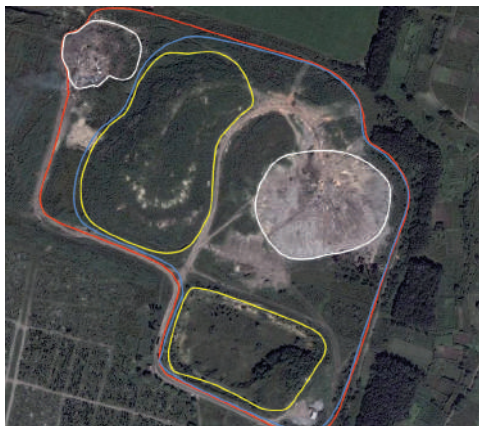
Рис. 8. Дистанційне зображення сміттєзвалища на околиці м. Біла Церква станом на 2006 р., зроблене з космічного апарата Quick Bird. Віддешифрований контур сміттєзвалища: блакитний колір - станом на 1986 р., червоний - станом на 2006 р. Карти складування побутових відходів: жовтий колір - станом на 1986 р., білий - станом на 2006 р.
