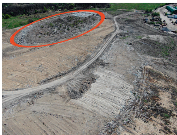
Рис. 4. Перспективне дистанційне зображення південної частини карти «А» полігона № 5, зроблене з безпілотного літального апарата 31.05.2019 р., яке дає змогу контролювати процес рекультивації сміттєзвалища (покриття інертним ґрунтом), розпізнавати його внутрішню «структуру», шлях проїзду по ньому, озеро для збору фільтрату, покрите захисним шаром (окреслене червоним кольором)
