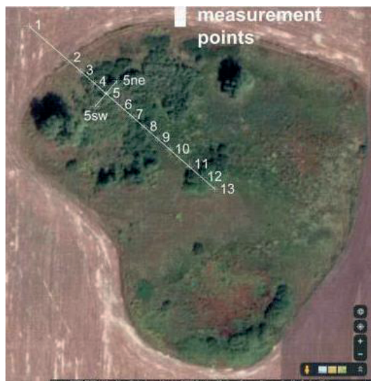
Рис. 2. Супутниковий знімок локальної зони вимірювань дегазації водню в депресії за 30 км на схід від Києва [30]
